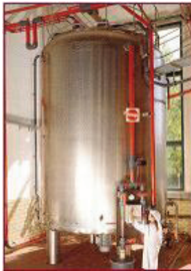
Şekil 5. Daldırma yöntemi ile fermantörde sirke üretimi (5-10 ton/gün % 4-6'lık asit) (8,9)
